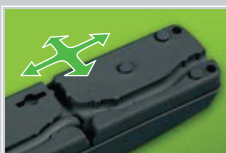
ČTYŘI MOŽNÉ SMĚRY ULOŽENÍ NAPÁJECÍHO KABELU
